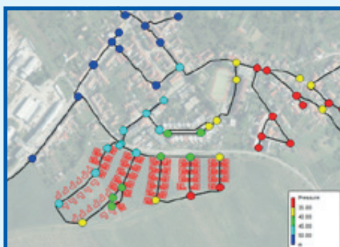
Náhled na hydraulické posouzení plánovaného vodovodu v rámci územní studie.
