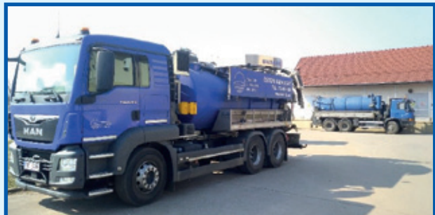
V popředí nové kanalizační kombinované vozidlo
