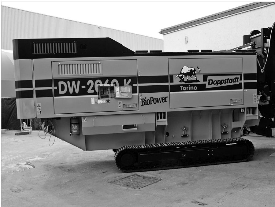
Zařízení Doppstadt DW 2060 K BioPower, které bude zpracovávat objemný odpad.
