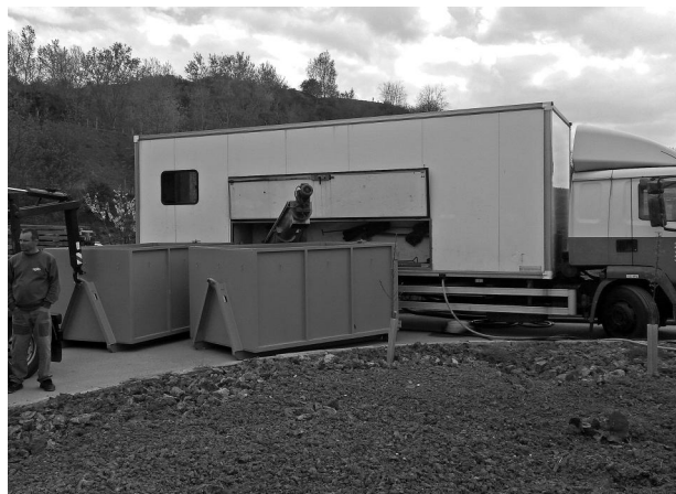
Foto 4 - odstředivka kalů v provozu.
